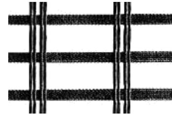
Las Geogrillas uniaxiales de poliéster son flexibles y sin memoria. Con un eje notoriamente más resistente que el otro se utilizan en la elaboración de plataformas como muros de Tierra Estabilizada Mecánicamente.
