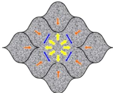
Las Geoceldas son un sistema de confinamiento celular en base a una retícula en forma de panal de abeja que se despliega para cubrir grandes superficies con un material liviano, compacto y fácil de transportar pero de alta resistencia capaz de distribuir cargas puntuales grandes áreas. Principalmente se utilizan para reforzamiento de suelos, fundaciones y carreteras, para protección de erosión en taludes y recubrimiento de ríos y canales.
