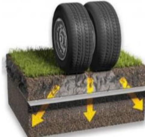
El material utilizado para el relleno empujará de forma uniforme las paredes de cada celda expandiéndola al mismo tiempo que el relleno de las celdas contiguas la contienen.
